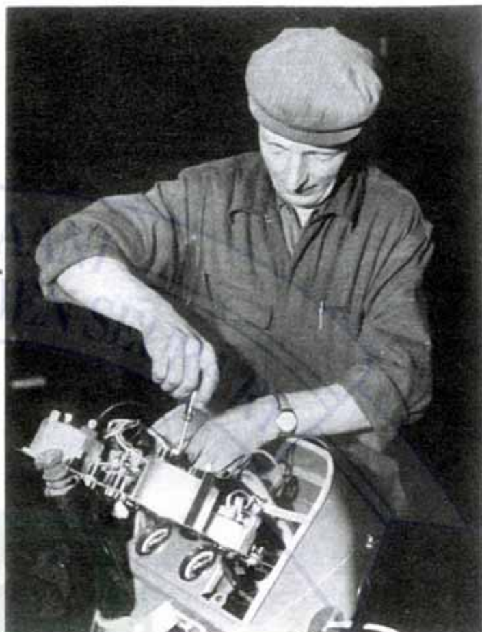
Suurta tarkkuutta vaatii kojetaulun alla olevien johtimien asennus. Kuvassa on sähköasentaja Jaakko Hutri tutussa työympäristössään.
