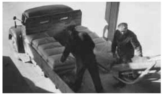
Kalkki- tai lannoitesäkkikuorma tyhjenemässä koneellisen kuljettimen avulla jossakin terminaalissa.
