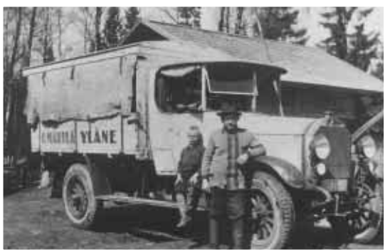
Kuljettaja Onni Mäkilä. 1923 ostettu M-B, jossa oli aluksi umpikumirenkaat, mutta vaihdettiin myöhemmin ilmarenkaisiin. Mäkilällä ollut lupa harjoittaa kuorma- ja henkilöliikennettä Yläneen Heinjoen kylässä.
