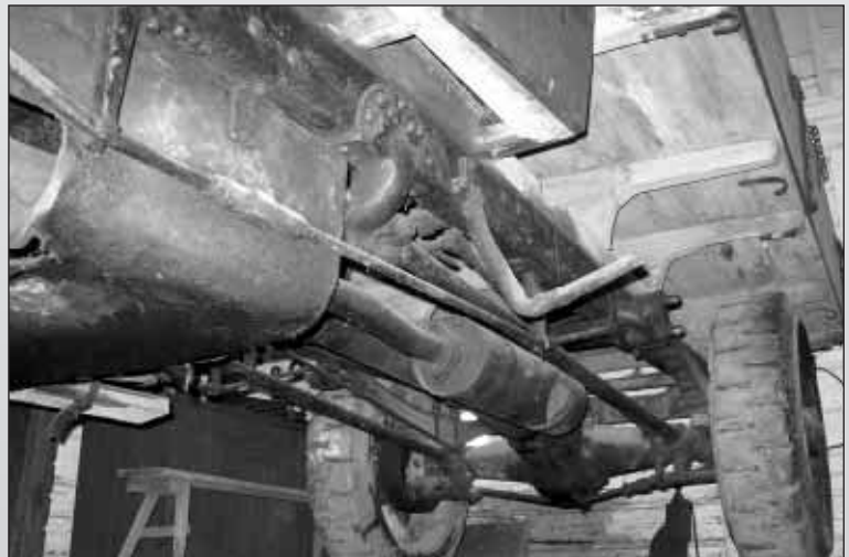
Tekninen erikoisuus: Benzin alustassa, sivupalkkien alla on muttereilla säädettävät rungon jäykistinraudat.
