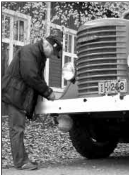
Laitteiston asennus on tarkkaa puuhaa. Jari kiinnittämässä moottorin ääntä tallentavaa mikrofonia karvapalloon.
