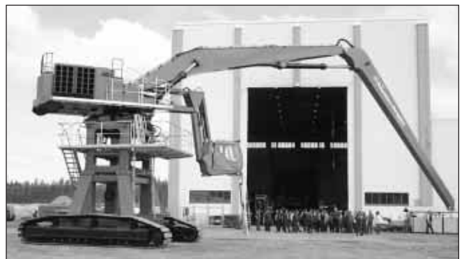
Jättiläinen. Mantsinen 100 RHC:n puomistolla taakkoja voi nostaa 23 metrin päältä ja siirtää ne nopeasti, tarkasti ja turvallisesti yli 40 metrin päähän. Portaattomasti liikuteltavassa ohjaamossa on äänen- ja värinänvaimennus, kuljettajan mukaan säädettävä hallintalaitteisto ja istuin, äänentoistolaitteisto ja jopa jää- ja kuuma-kaappi virvokkeita varten. Painoa tällä isolla virkkuukoukulla on 97 000 kg.
