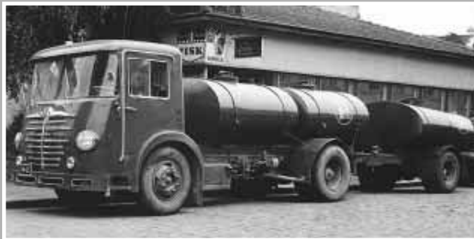
Bussing 4500 U, 6-syl. 4-tahtisella etukammiodiesel vaakamoottorilla varustettu tehokuljetin vuodelta 1955. 5.43 litrainen moottori kehitti 100 hv/2600 rpm. Vaihteet 5+1. Paineilmajarrut.
