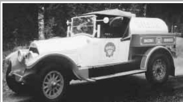
Cadillac Type 55 Sedan /1917. Auto on tuotu käytettynä Suomeen v. 1920. Ollut August Eklöfin yhtiön käytössä v. 1934. Muunnettu paloautoksi, jossa käytössä vuoteen 1958. v. 1966 Oy Shell Ab osti hylyn ja rakensi siitä yhtiölle mainosauton, rekisteröitiin v. 1969. Moottori 5,24 V/8, vaihteet 3+1, mekaaniset jarrut takapyöriin.
