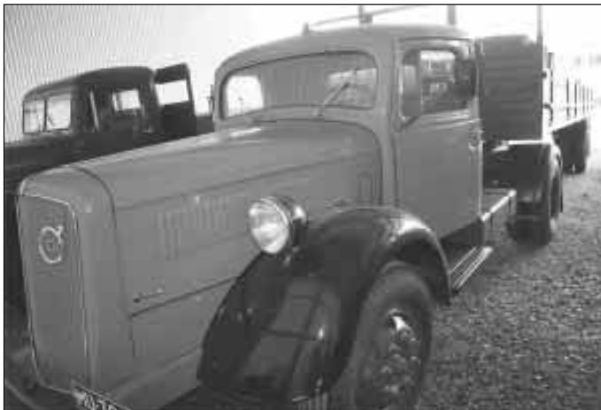
Tämä Vuoden 1940 Volvo Lv 290 D on entisöity Petsamon-Liinahamarin liikenteen rekaksi. 150 hevosvoimiseen auto on ollut aikansa voimapaketti Jäämerentiellä. Lavarakenteista ei ollut olemassa tarkkoja mittoja, mutta vanhojen valokuvien perusteella oikea koko löytyi. - Laskimme kuvasta montako tynnyriä samanlaisen lavalle oli sijoitettu ja teimme mitoituksen sen mukaan.
