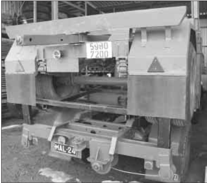
Pertti Lähivaaran ensimmäisenä entisöimän 1942 mallisen Volvon puuvarustus on monipuolinen. - Tässä on koko kuormausvehkeitten historia ajalta ennen vajerinostureita. Autolla voi tehdä vaikka kolmenlaista lastausnäytöstä, naruilla, käsivinsillä ja konevinsillä.
