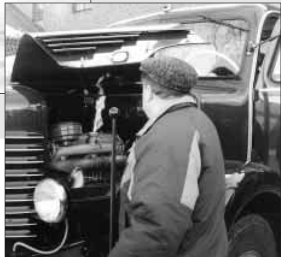
Paavo Vainikan Vanaja VAK/4800 vm. 1957:n Leyland O.350 vaati käynnistyäkseen vanhanajan hehkutusta. Hehkuttamassa Kalervo Mesiranta.
