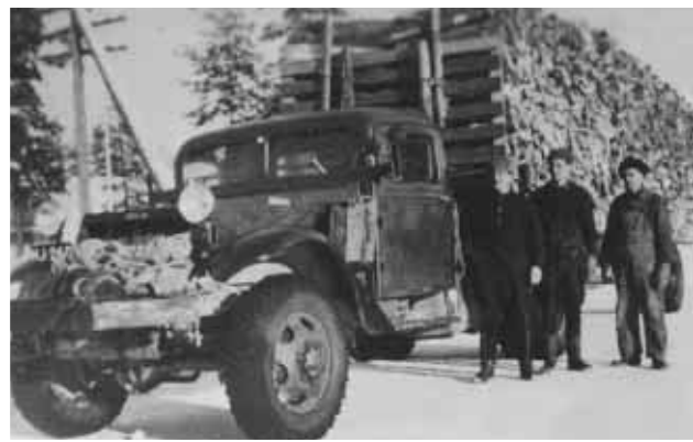
White Half Track M2A1 4x4/ 1944. Halkokuormassa 35 m 3 . Kuvassa vuonna 1950 Toivo Sallinen, Veikko Aulén ja Matti Kivi. Whittessä, joka oli muutettu telavaunusta pyöräautoksi, oli 6-syl. 147 hv bensiinimoottori.
